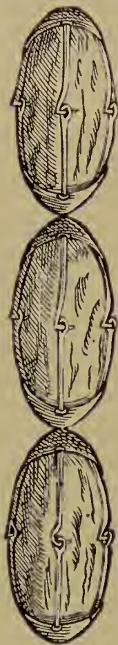
Abb. 33. Gilberts Versuche mit armierten Magneten. (Gilbert, De magnetibus cap. XX.)
